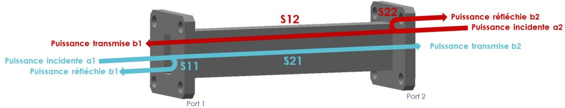
FIGURE 2.10 – Représentation des ondes incidentes  $a_i$  et réfléchies  $b_i$  aux ports d'un guide d'ondes
