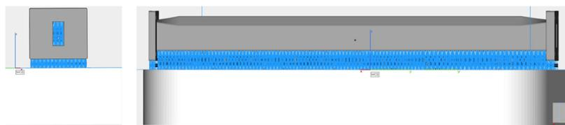
FIGURE 5.43 – Structures de supportage générées automatiquement par le logiciel Magics pour les géométries développées pour l'alliage AlSi7Mg0.6 : (à gauche) vue transversale (à droite) vue longitudinale
