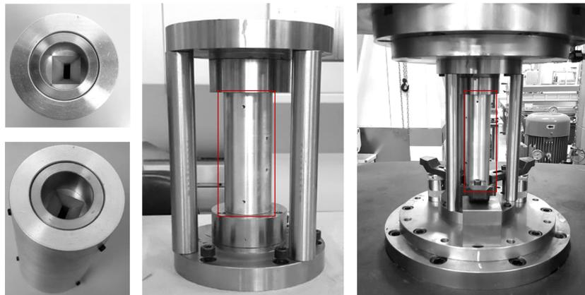
FIGURE 5.49 – Outillage conçu pour la géométrie développée en titane (en rouge) pour le traitement de surface AFM, intégré à l'outillage de la machine VECTOR 200
