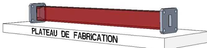
FIGURE 5.8 – Orientation choisie pour la fabrication
