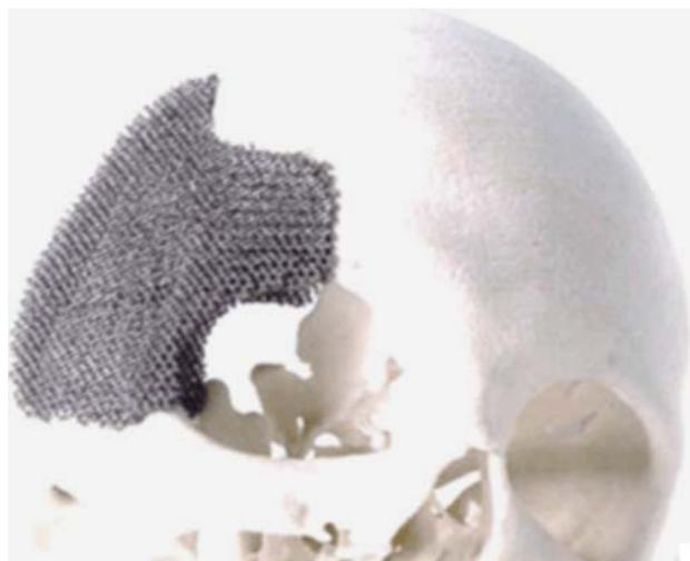
Figure 9 – Volet-crânien en Ti6Al4V obtenu avec un procédé de fusion sur lit de poudre (crédit Murr, et al. [4])
