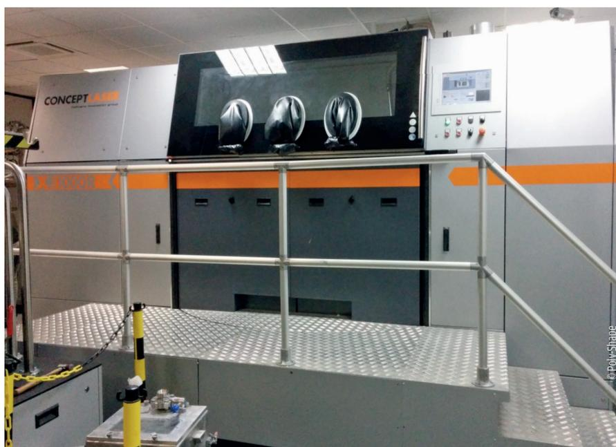
FIGURE 3 : Modèle XLine 1000R de Concept laser, grand volume de fabrication.
